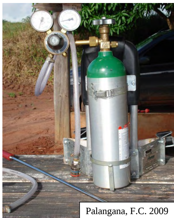
Figura 1. Pulverizador costal pressurizado de CO 2 com pressão constante. São Manuel-SP – FEPP - UNESP/FCA, 2009.
