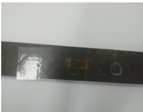
Figura 34. Centralização do strain gage no corpo de prova
