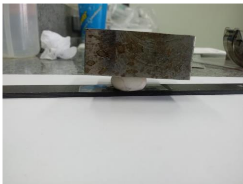
Figura 35. Colagem do strain gage
