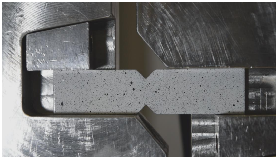
Figura 14. Vista do posicionamento dos corpos de prova no Ensaio de Iosipescu (cisalhamento puro)
