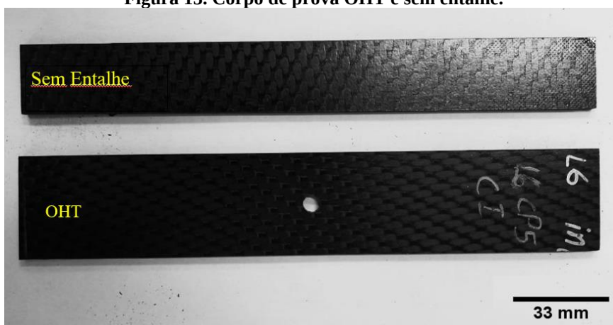
Figura 13. Corpo de prova OHT e sem entalhe.
