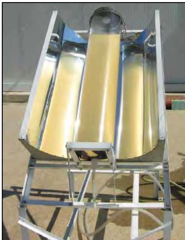
Figura 6 - Reator solar aperfeiçoado cheio com água de 100 NTU de turbidez (Fonte: UBOMBA-JASWA et al., 2010).
