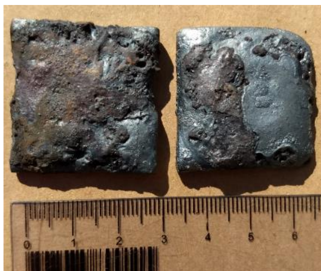
Figura 16 - Amostras revestidas pelo processo de soldagem GTAW
