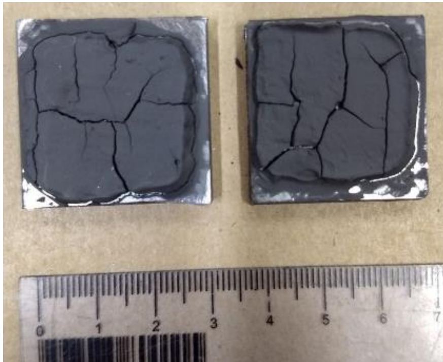
Figura 13 - Camada de mistura carbonetante depositada sobre o substrato
