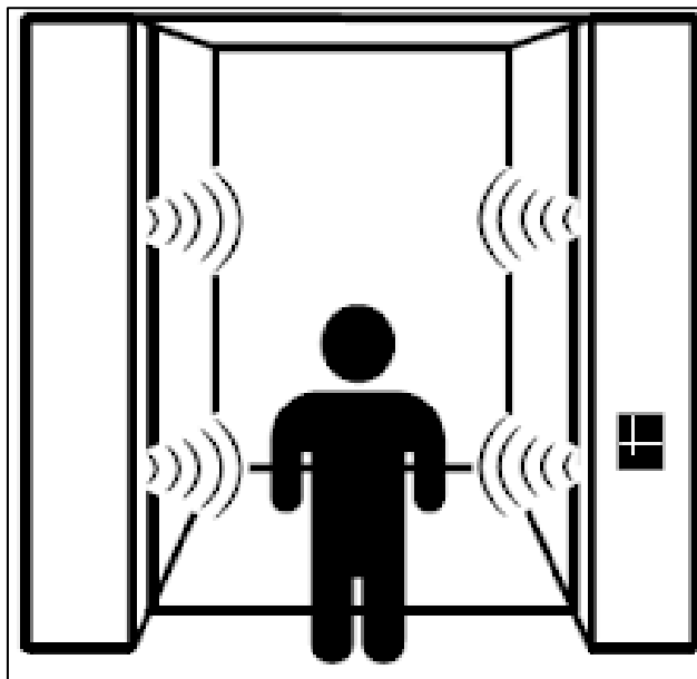
Figura 25 - Elevador com sensor permitindo que as pessoas entrem sem o risco de a porta fechar durante o trajeto.
