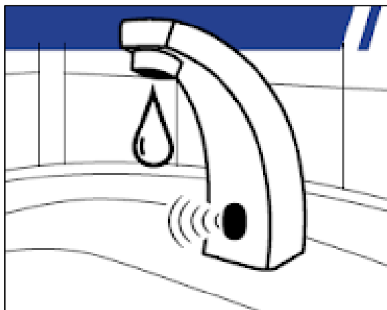
Figura 26 - Torneira com sensor para saída de água.
