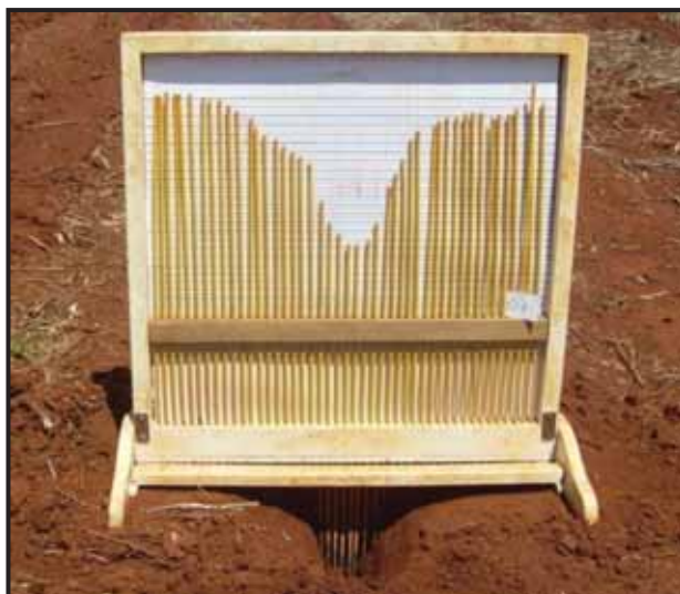
Figura 10. Perfilômetro de varetas para determinação da mobilização do solo.
