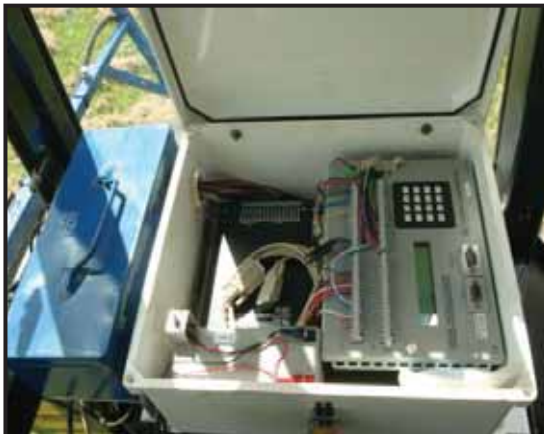
Figura 7. Sistema de aquisição de dados utilizado.
