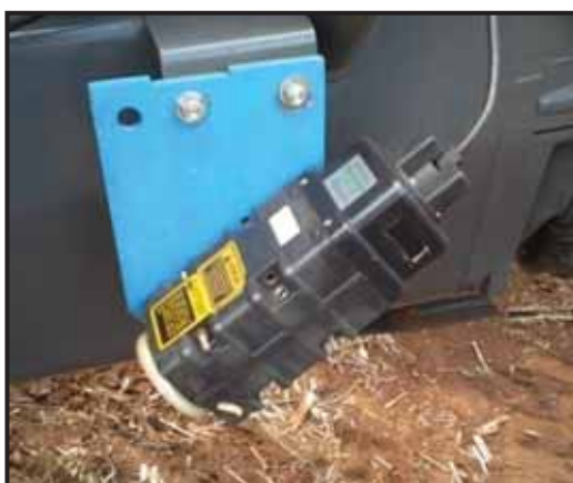
Figura 8. Radar, alinhado com ângulo de 45° em relação ao solo.
