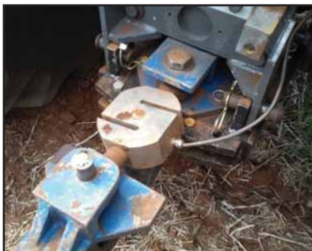
Figura 11. Célula de carga utilizada.
