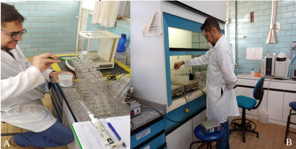
Figura 5 – A-) Preparação das amostras de folha e planta para digestão. B-) Digestão sulfúrica do material (folha e planta inteira).
