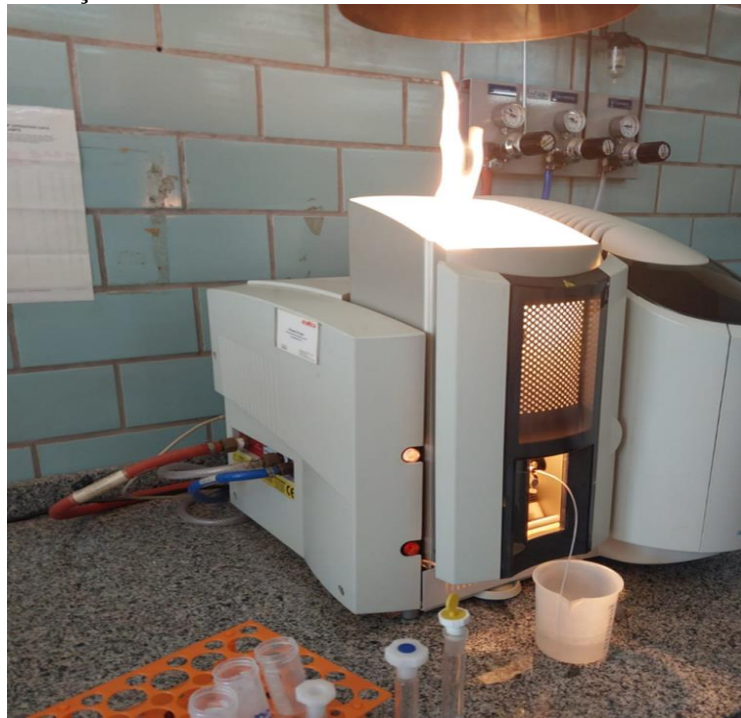
Figura 9- Determinação de Ca, Mg, K e Micro nutrientes (foliar e planta inteira) pelo espectro fotômetro de absorção atômica.
