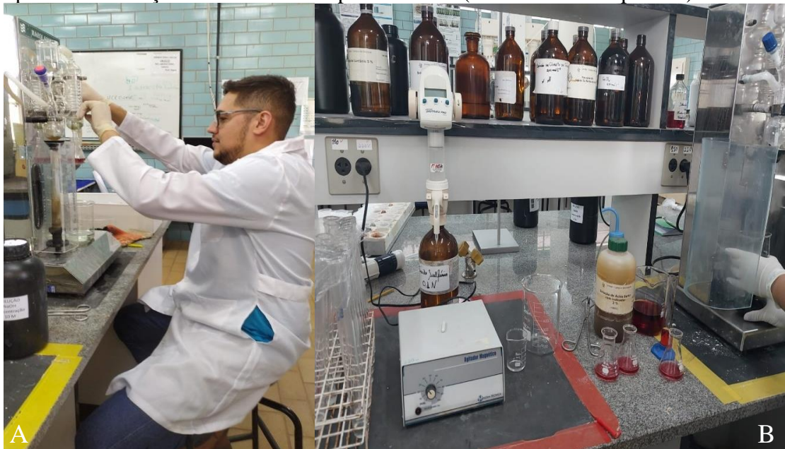
Figura 6 – A-) Destilação das amostras B-) Titulação pelo método micro Kjeldahl, para determinação de N em folha e planta inteira (folha + colmo + pendão).
