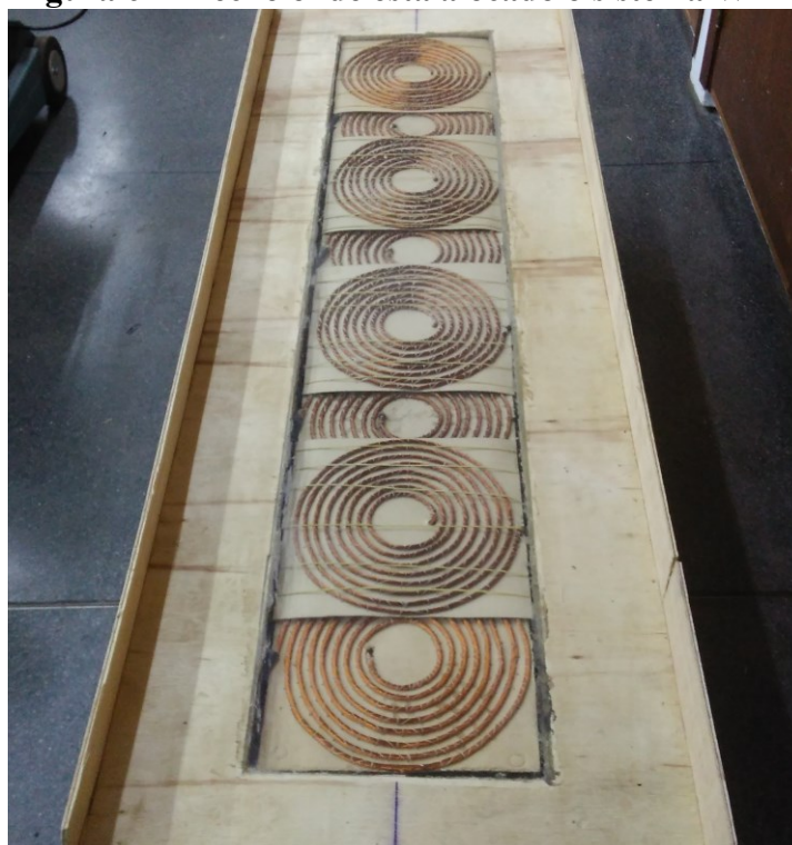
Figura 6 - Trecho onde está alocado o sistema WPT.
