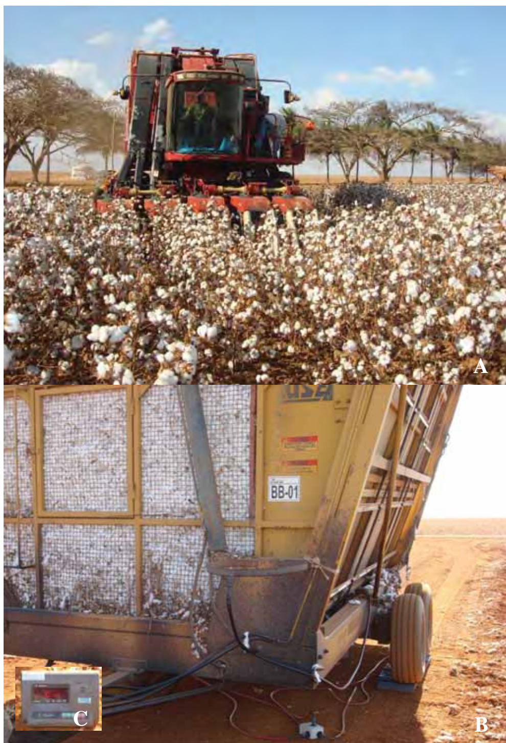
Figura 5. Cultura do algodão no dia da colheita (A); Sistema para pesagem do algodão em caroço (B) e; Detalhe do medidor (C).
