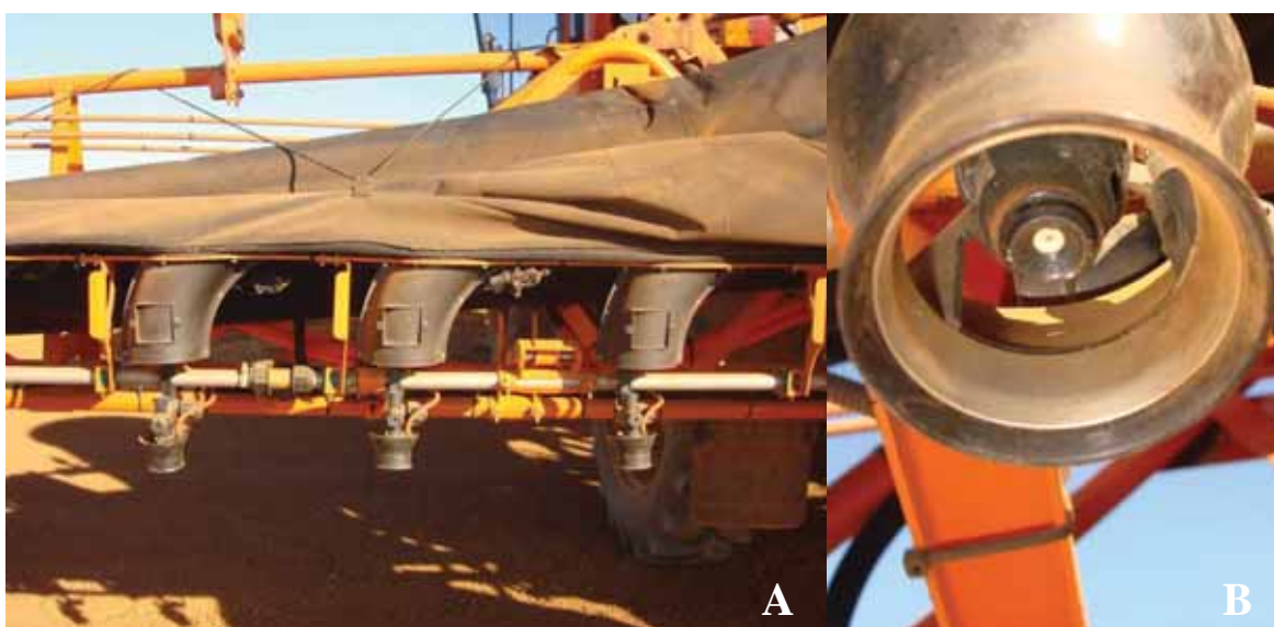
Figura 2. Detalhes da barra de pulverização do protótipo: A. Conjunto de pontas mostrando a saída de ar e; B. Ponta de pulverização jato cônico vazio JA-2 e eletrodo de indução de carga elétrica.
