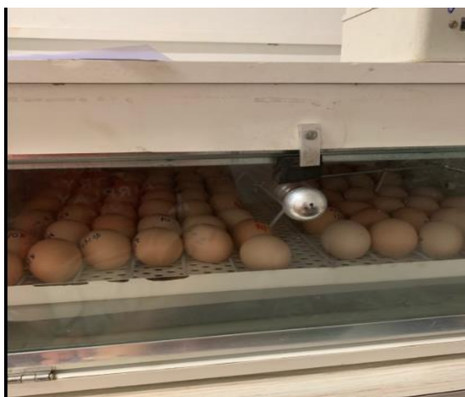
Figura. 3: Ovos embrionados incubados em uma incubadora de acordo com os parâmetros de humidade e temperatura indicados pelo manual da linhagem
