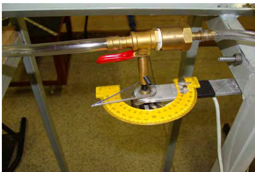
Figura 5.3 – Protótipo: válvula para graduação de diferentes graus de obstrução do fluxo aéreo
