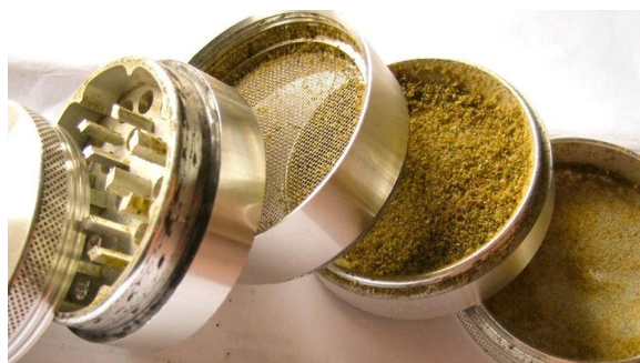
Figura 7: Extração a seco por dichavador trifásico
