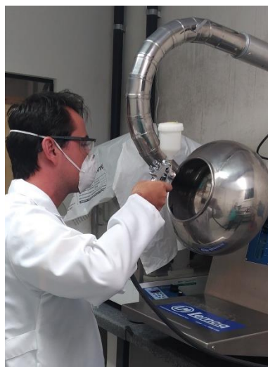
Figura 04: Posição da drageadeira e da pistola de atomização da solução de revestimento durante o processo de aplicação manual da película de revestimento.
