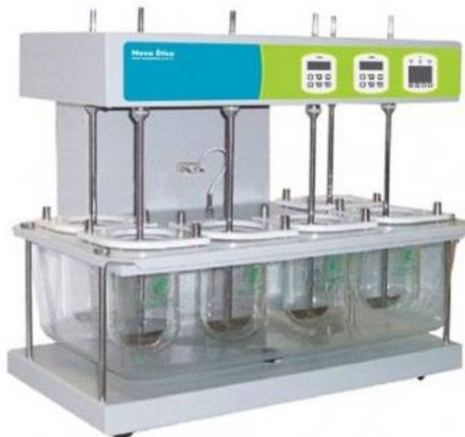
Figura 04: Aparato USP II para ensaio de dissolução desenvolvido pela Nova Ética
