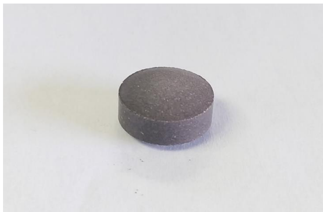
Figura 01: Comprimido magnético após processo de compressão manual
