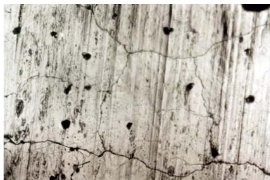
FIGURA 2.31 – Observação indireta da superfície de um cilindro em HCl após campanha final mediante réplica. Verificou-se mais nitidamente a presença de sulcos de abrasão e malha de trincas térmicas. (IPT, 2001)
