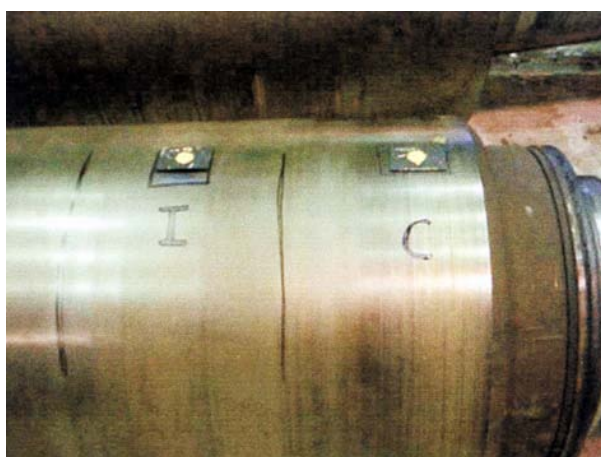
FIGURA 2.29 – Réplica do dano superficial mediante aplicação de resina polimérica. Após limpeza da superfície, aplica-se uma mistura de resina com catalizador em um molde montado na superfície do cilindro, depois de endurecida, a mesma é levada ao microscópio para observação.(IPT, 2001).
