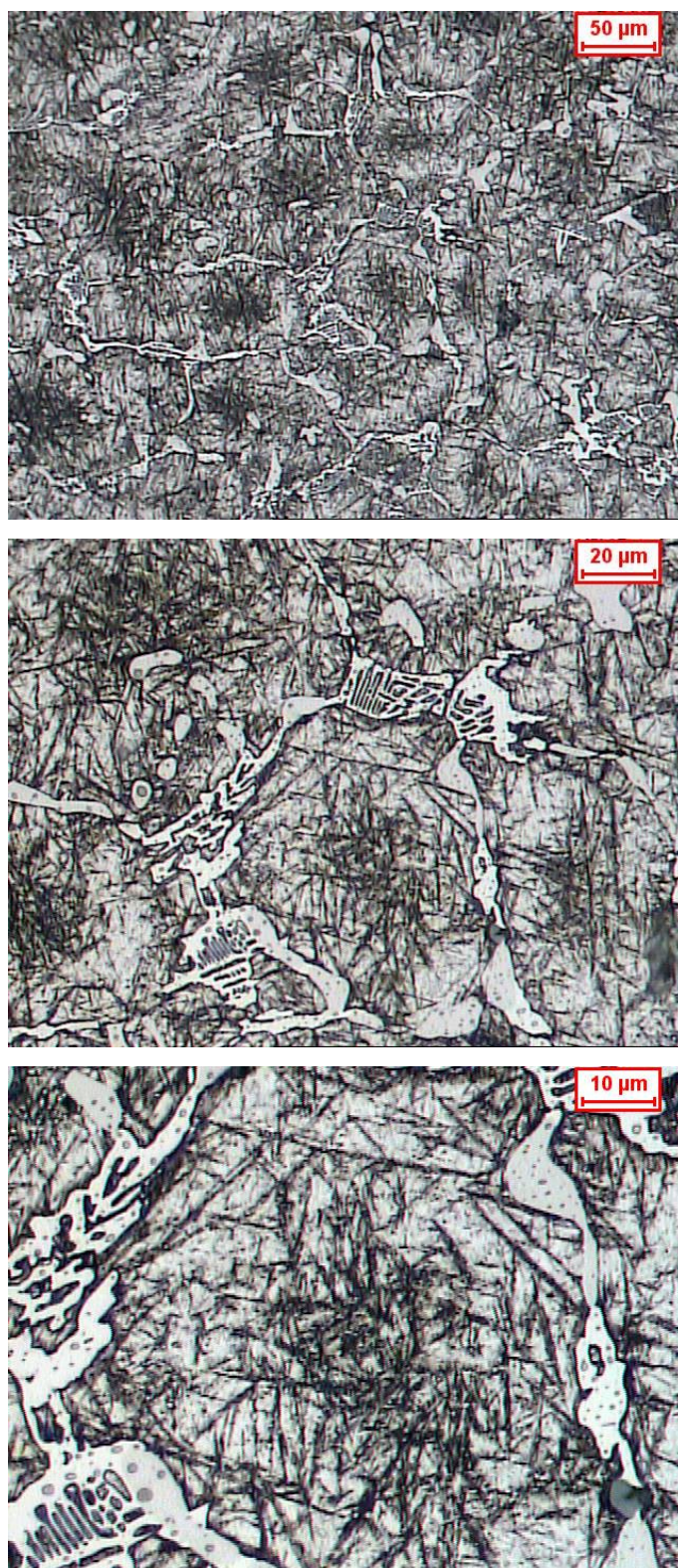
FIGURA 4.3: Microestrutura do aço rápido (HSS), ataque nital x 15s. Rede complexa de carbonetos eutéticos e carbonetos oriundos de precipitação secundária em matriz martensítica com ocorrência de bainita. Diferentes ampliações.
