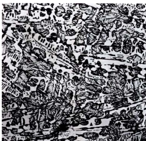
FIGURA 2.17 – Micrografia de um ferro fundido indefinido – IC ( The Institute of British Foundrymen , 1981).
