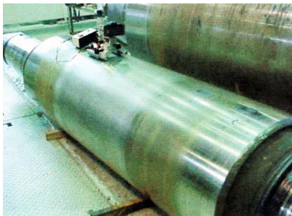
FIGURA 2.28 – Observação do dano superficial mediante microscopia ótica portátil. Foi utilizado microscópio dotado de máquina fotográfica tipo reflex 35mm. (IPT, 2001)
