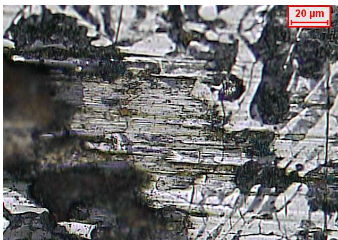
FIGURA 2.35 – Micrografia ótica da superfície de um cilindro produzido em ferro de coquilhamento indefinido. Verificou-se a presença de sulcos de abrasão e oxidação, as trincas observadas foram causadas por impacto na retirada da amostra. (Camargo & Cornélio, 2004).
