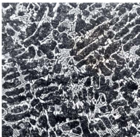
FIGURA 2.21 – Micrografia de um ferro fundido branco alto cromo, apresentada pelo The Institute of British Foundrymen (1981).
