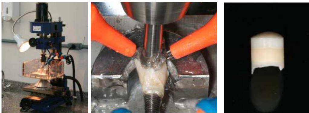
Figura 5 – Máquina de corte para amostras circulares (A); Dente sendo cortado com trefina diamantada de 6 mm (B) e espécime cortado (C).
