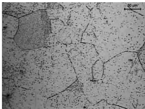
Figura 27a- Micrografia do aço inoxidável 304 tratado a 820°C – 1 hora, resfriamento ao ar. Figura 27b- Micrografia do aço inoxidável 304 tratado a 620°C – 24 horas, resfriamento ao ar.
