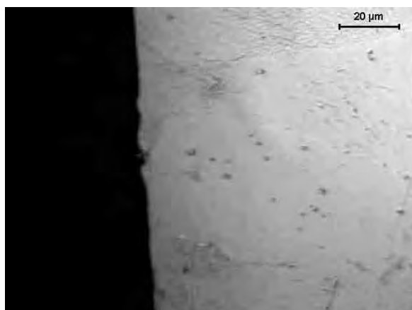
Figura 91b - A ocorrência da corrosão por pites no aço inoxidável 310S, tratado a 1065°C –1 hora e resfriada em água e gelo.
