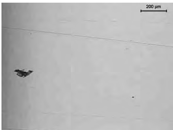
Figura 51a tratada a - 1065°C – 1 hora, resfriada água e gelo e exposição de 312 horas em névoa salina. Figura 51b - tratada a 1065°C – 1 hora, resfriada água e gelo e exposição de 312 horas em névoa salina.
