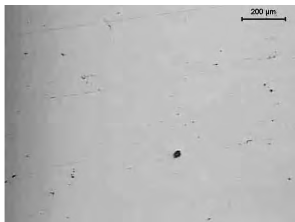
Figura 49b- Como recebida e exposição de 312 horas em névoa salina.
