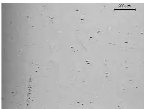
Figura 52a- tratada a 1065°C –1 hora, resfriada ao ar e exposição de 48 horas em névoa salina. Figura 52b- tratada a 1065°C –1 hora, resfriada ao ar e exposição de 48 horas em névoa salina.
