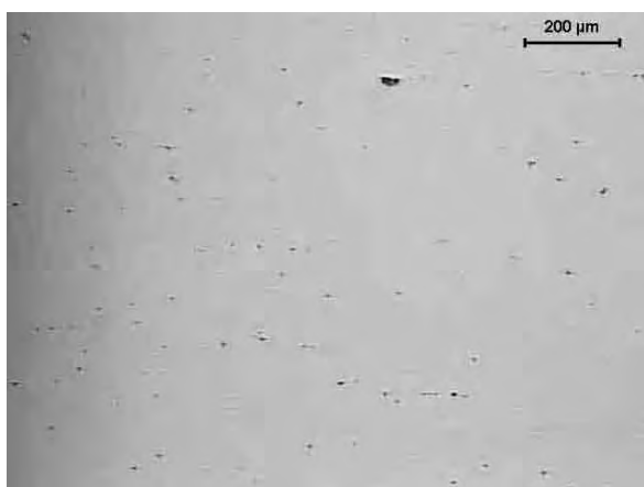
Figura 48a- Como recebida e exposição de 48 horas em névoa salina
