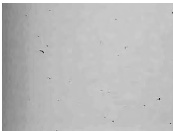
Figura 50b- tratada a 1065°C -1 hora, resfriada em água e gelo e exposição de 48 horas em névoa salina.
