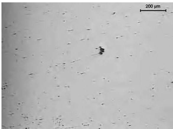
Figura 49a- Como recebida e exposição de 312 horas em névoa salina.
