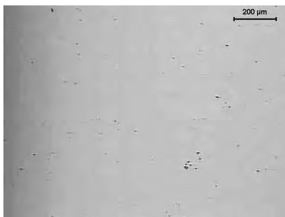
Figura 48b- Como recebida e exposição de 48 horas em névoa salina
