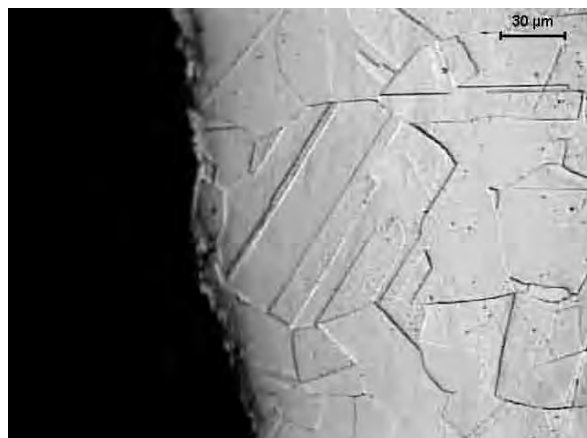
Figura 92b - A ocorrência da corrosão por pites no aço inoxidável 310S, tratado a 1065°C – 1 hora e resfriada ao ar.
