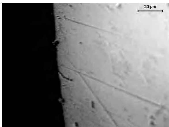
Figura 91a - A ocorrência da corrosão por pites no aço inoxidável 310S, tratado a 1065°C – 1 hora e resfriada em água e gelo.
