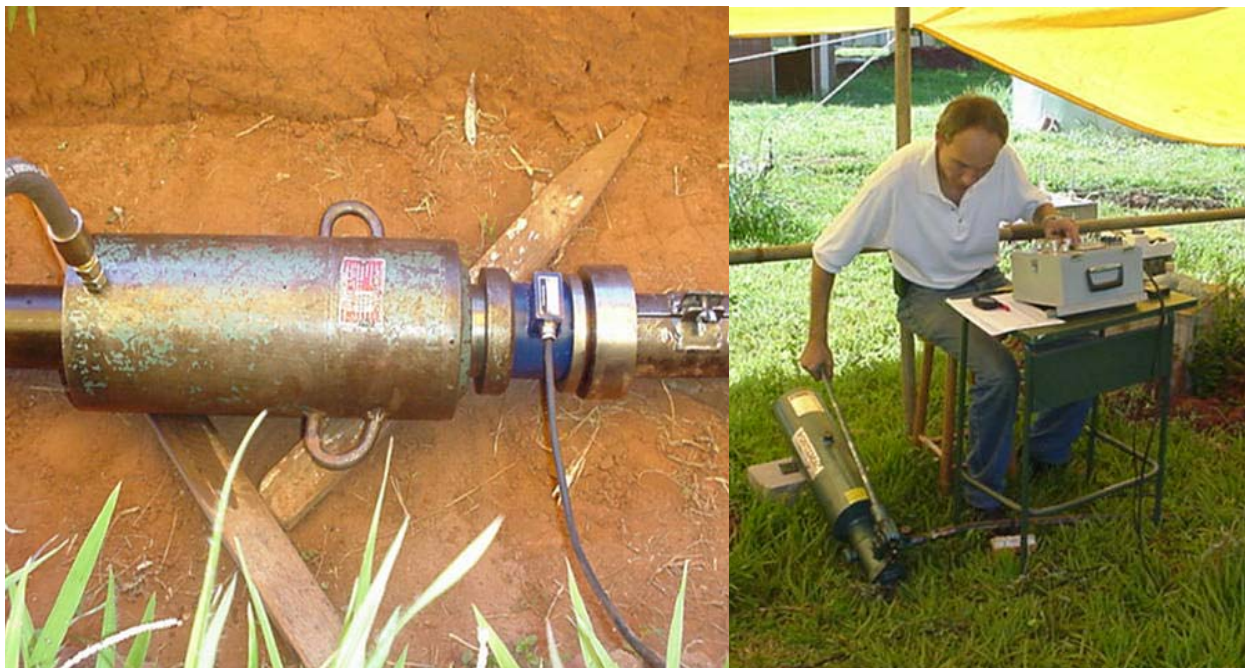
Foto 4.4. Detalhe do conjunto macaco e bomba hidráulica.
