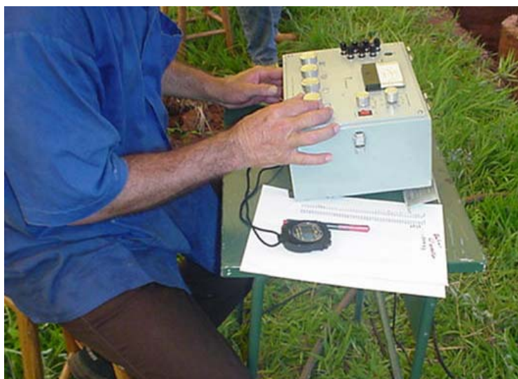
Foto 4.6. Controle de carga no macaco – Bomba hidráulica e indicador de deformação.
