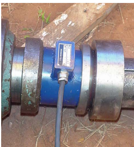
Foto 4.5. Detalhe da célula de carga utilizada nas provas de carga.
