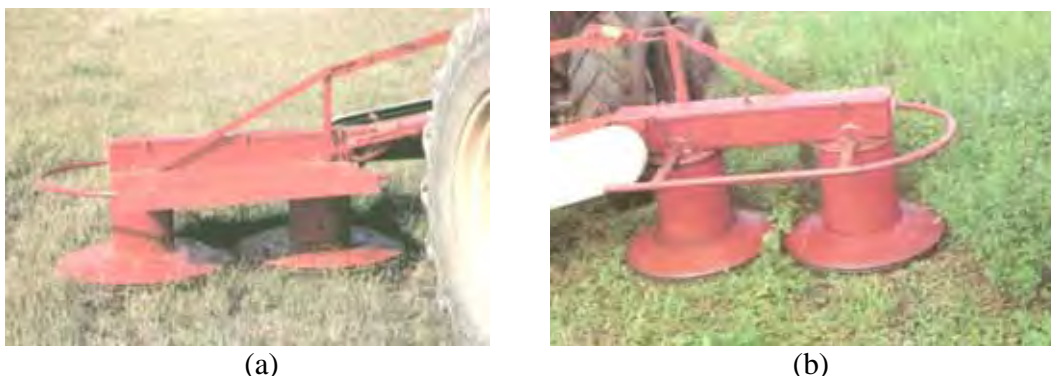
Figura 9. a) Segadora de dois discos utilizada para o corte da forrageira; b) Segadora promovendo corte de alfafa.
