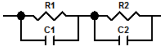
Figura 9 - Circuito equivalente proposto para modelagem das propriedades elétricas dos dispositivos eletroluminescentes quando excitados por sinais alternados.
