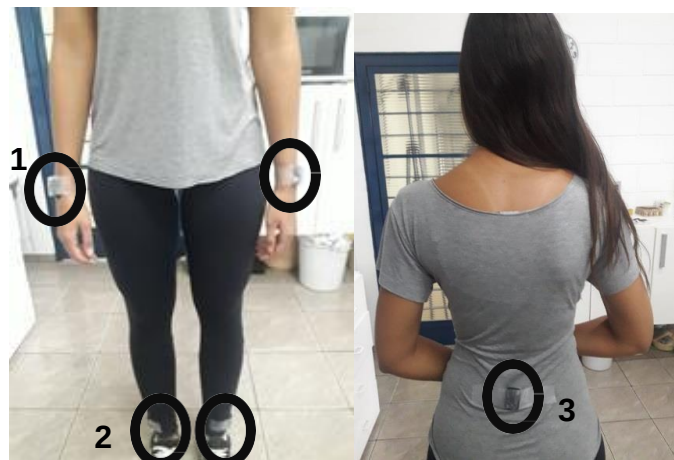
Figura 2: Posicionamento dos acelerômetros. (Acelerômetros posicionados nos punhos (1), tornozelos (2) e 5ª vértebra lombar (3)).
