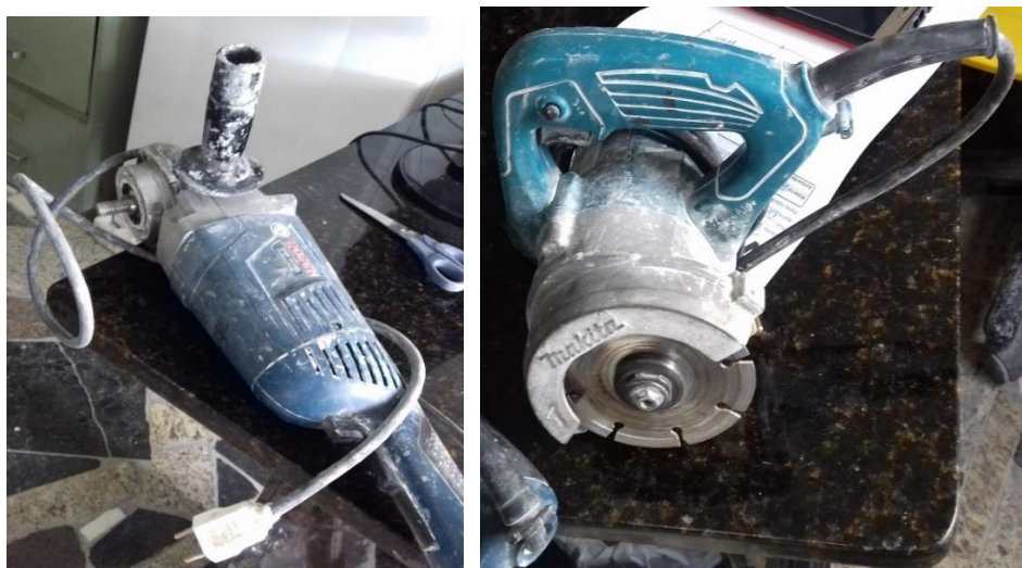
Figura 5: Politriz e máquina de corte para acabamentos específicos, utilizadas na marmoraria em estudo
