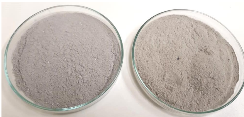
Figura 7: Resíduo de corte (esq.) e resíduo de polimento (dir.) armazenados para ensaios
