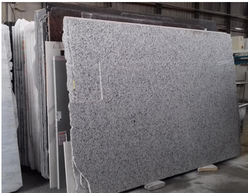
Figura 3: Chapas brutas de rochas ornamentais vindas de indústrias de extração e serragem
