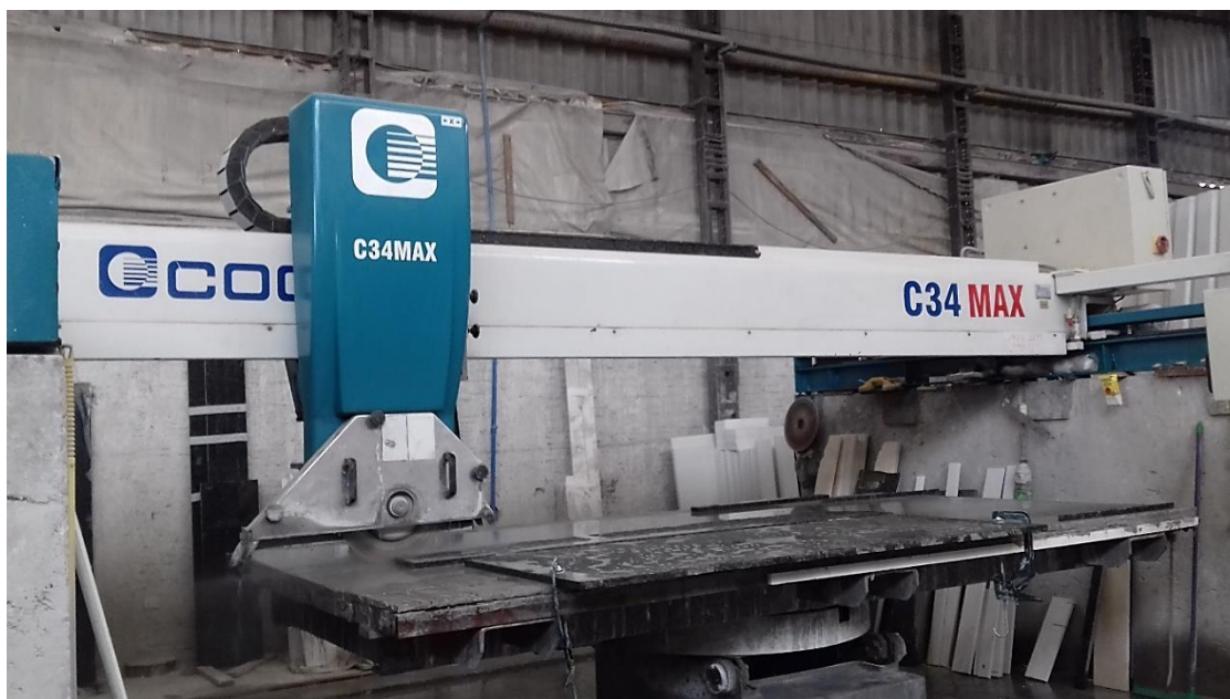
Figura 4: Serra-ponte cortando uma chapa bruta de rocha ornamental
