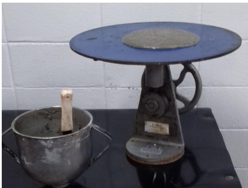
Figura 12: Espalhamento da argamassa após os golpes da mesa de adensamento
