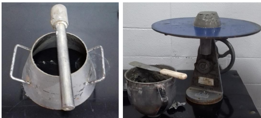
Figura 11: molde tronco cônico e soquete (esq.) e mesa de adensamento com argamassa após a retirada do molde (dir.)
