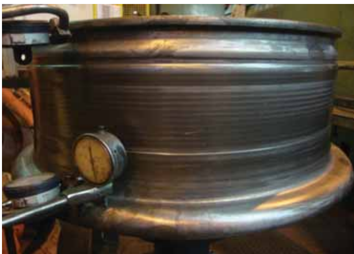
Figura 5: Foto do dispositivo de medição de batimento (Fonte: Autor).
