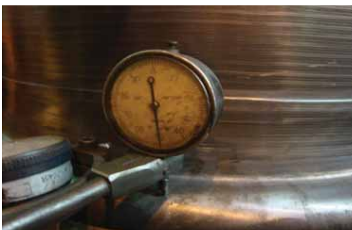
Figura 7: Detalhe do relógio de leitura do batimento lateral (Fonte: Autor).
