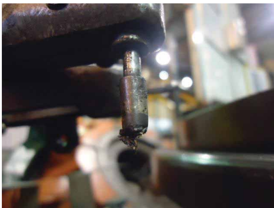
Figura 10: Acúmulo de sujeira no dispositivo de medição (Fonte: Autor).
