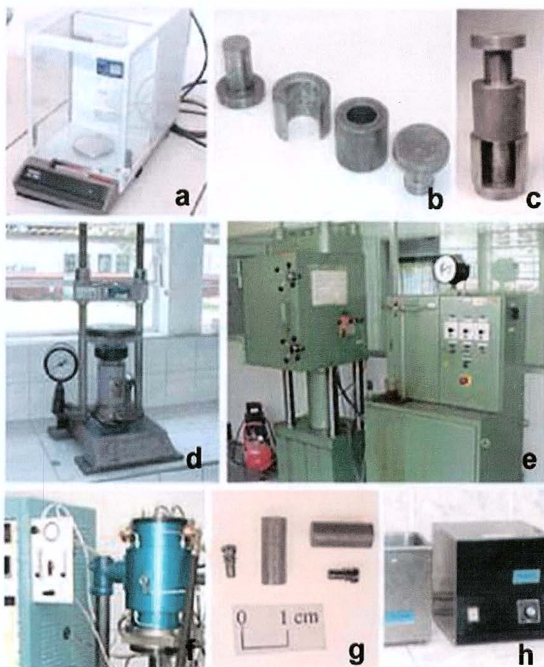
FIGURA 1 – Aparelhos utilizados na obtenção dos implantes metálicos. a) balança analítica digital utilizada para pesagem dos pós metálicos. b) matriz com camisa flutuante desmontada para compactação dos pós. c) matriz montada. d) prensa hidráulica vertical usada na primeira prensagem. e) prensa isostática utilizada para prensagem final. f) forno de sinterização com atmosfera controlada. g) pinos obtidos e parafusos usinados. h) ultra-som utilizado na limpeza dos implantes.
