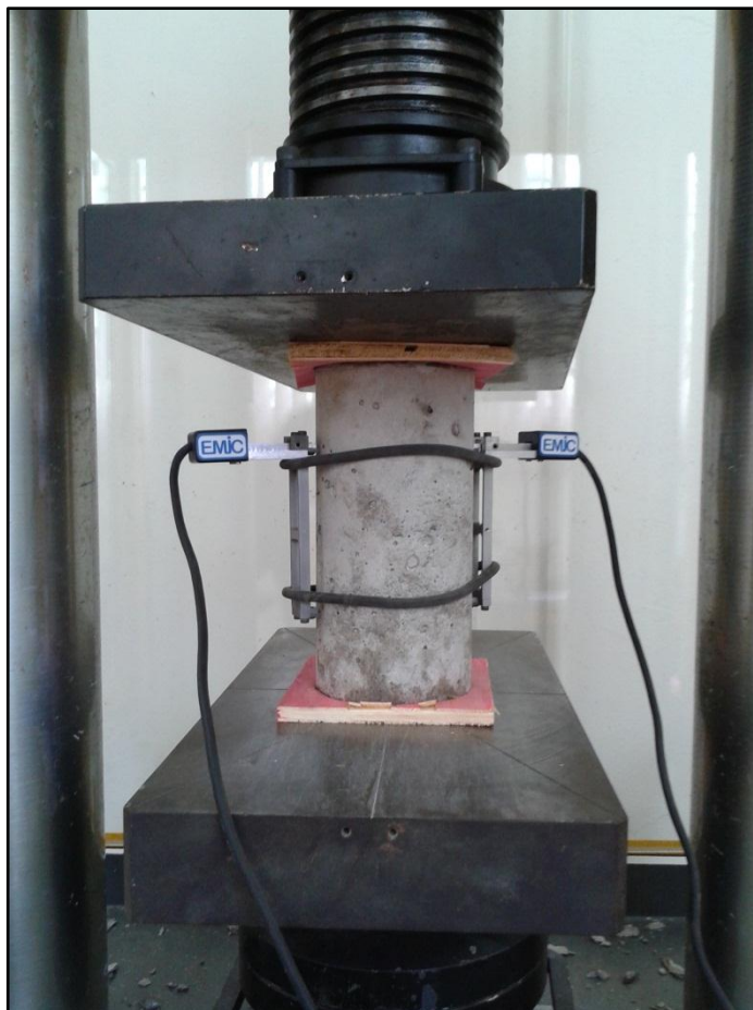
Figura 14 - Ensaio do módulo de elasticidade
