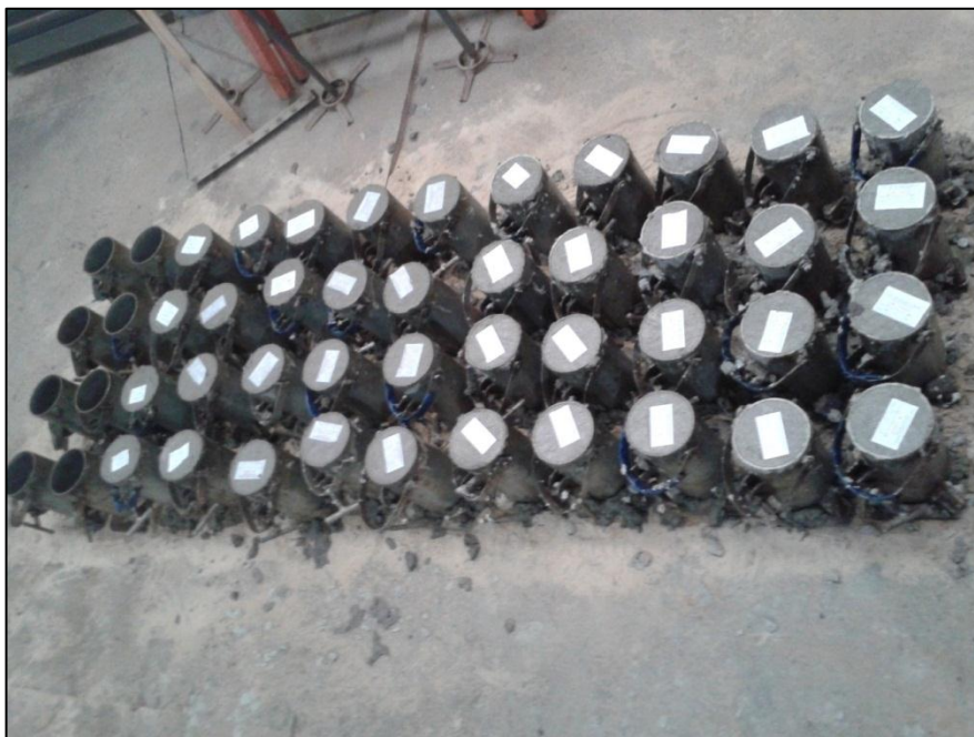
Figura 7 - Molde corpo de prova cilíndrico
