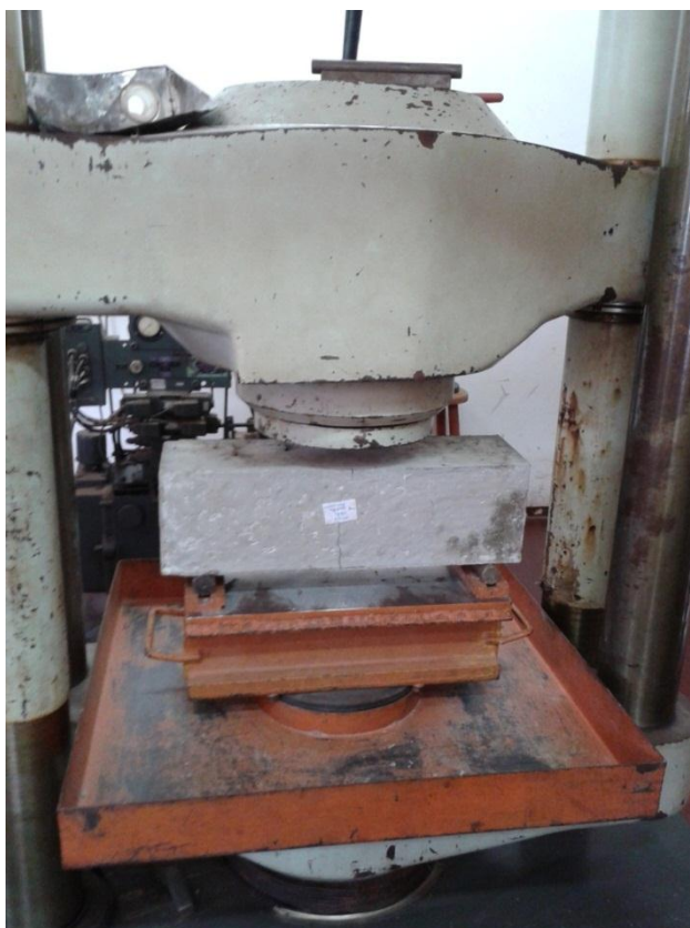
Figura 13 - Representação esquemática do ensaio de flexão de 3 pontos
