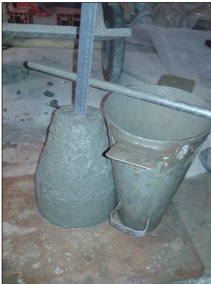
Figura 9 - Ensaio de abatimento
