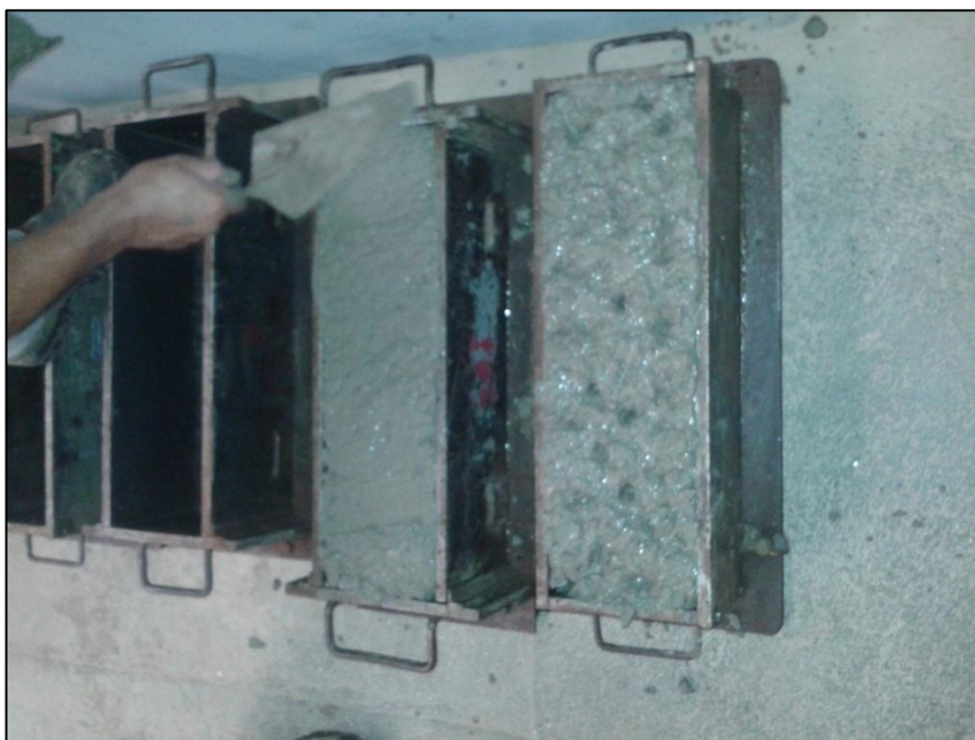
Figura 8 - Molde corpo de prova prismático
