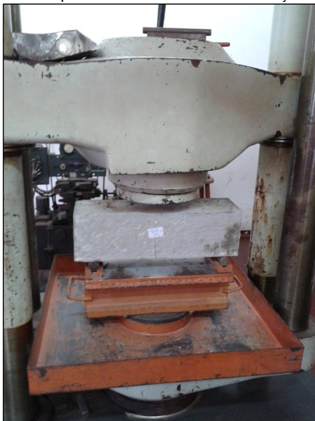
Figura 11 - Máquina de ensaio mecânico à tração na flexão
