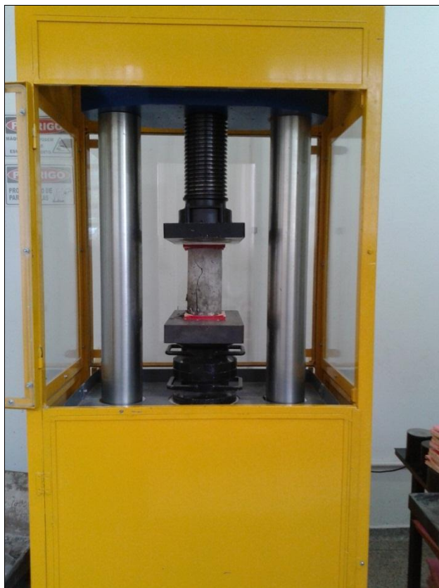
Figura 10 - Máquina de ensaio mecânico à compressão e módulo de elasticidade
