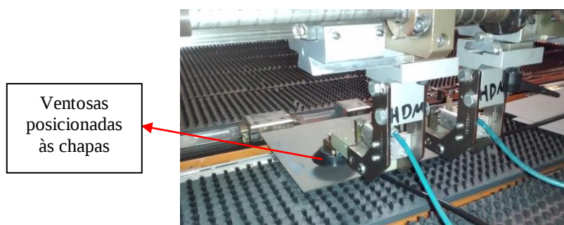
Figura 29- As chapas começando a serem posicionadas para a “captura” das ventosas (esse processo ocorre dos dois lados).
