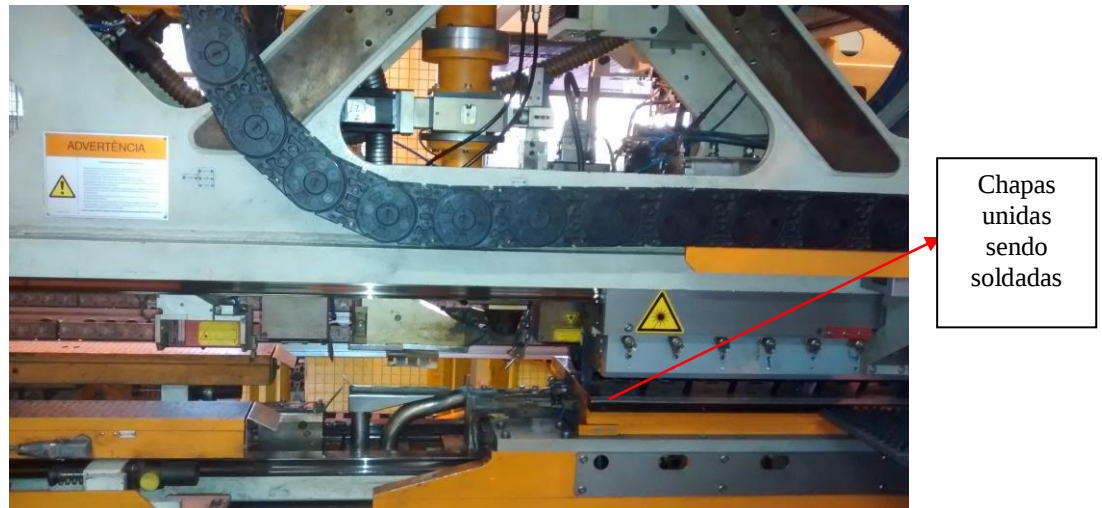
Figura 31- Momento em que as chapas unidas são soldadas por meio do laser junto com sistema de monitoramento.
