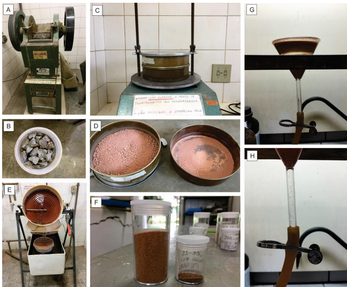
Figura 2 – Etapas de preparação das amostras. (A) Britador a mandíbula utilizado na britagem das amostras da Formação Apazível. (B) Amostras após britagem. (C) Peneira de 180µm utilizada para o peneiramento. (D) Parcela mais grossa (à esquerda) e mais fina (à direita) após peneiramento. (E) Bateia mecânica utilizada para separação das parcelas de minerais leves e pesados. (F) Concentrado de minerais leves (à esquerda) e de minerais pesados (à direita). (G) Separação de minerais pesados através de bromofórmio, observa-se na foto a concentração de minerais leves como material sobrenadante no líquido denso. (H) Imagem em detalhe do funil com bromofórmio apresentando os minerais pesados decantados.
