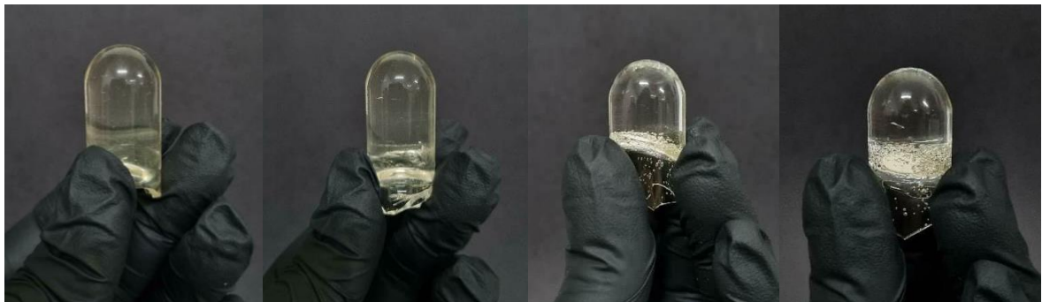
Figura 15 - Pré-formas produzidas a partir das amostras REN68, REN69, FOS70 e FOS71 respectivamente.
