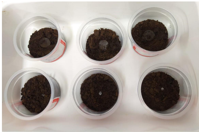
Figura 11 - Arranjo do teste de biodegradação das lâminas e dos pellets na superfície do solo antes de serem enterrados
