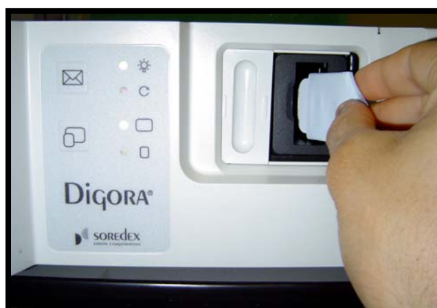
FIGURA 3 – Leitor do Scanner do Sistema Digora. Sensor sendo introduzido para captura da imagem.
