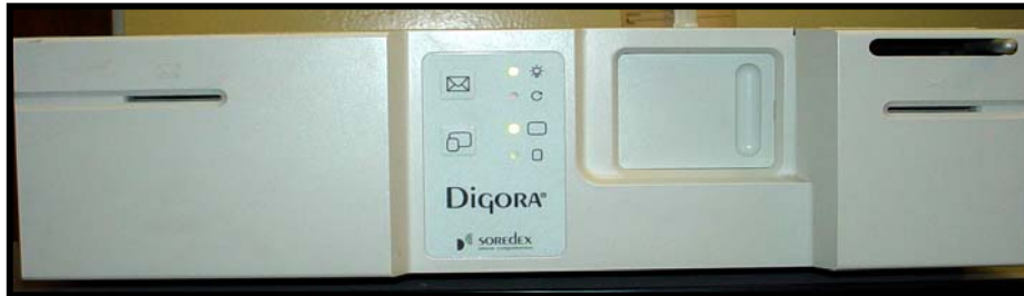
FIGURA 1 – Scanner Digora, utilizado para leitura do sensor de placa de fósforo.
