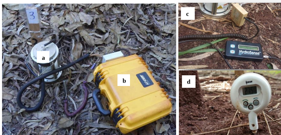
Figura 2. Câmara para solo inserida sobre o colar de PVC (a), sistema LI-8100 interligado à câmara de solos (b), TDR - Hydrosense system, para avaliação da umidade do solo (c) e sensor de temperatura de haste (d).
