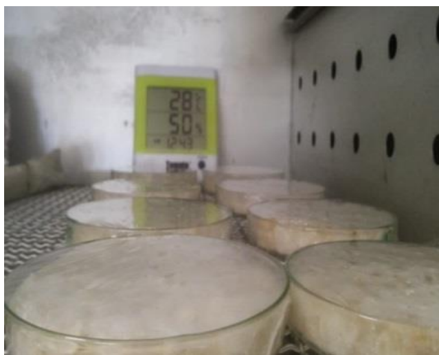
Figura 14: Placas contendo a mistura dos cotilédones de soja e fatias dos tubérculos de junça inoculados com o fungo Rhizopus oligosporus , e incubadas em estufa a 30 °C ± 1
