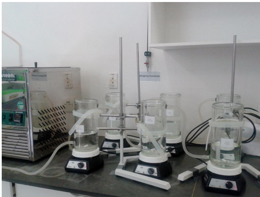
Figura 2 – Experimentos em microcosmos: reatores de vidro encamisados conectados ao banho termostatizado utilizados para os estudos de cinética de consumo de peróxido de hidrogênio.
