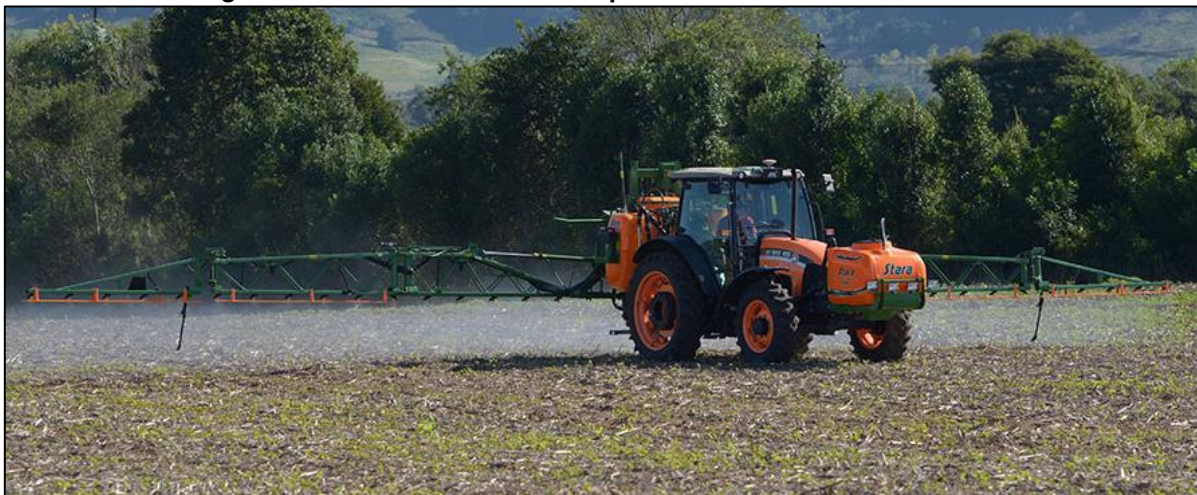
Figura 2 - Características de um pulverizador de barras montado
