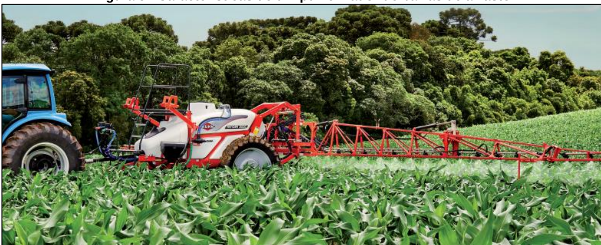
Figura 3 - Características de um pulverizador de barras de arrasto
