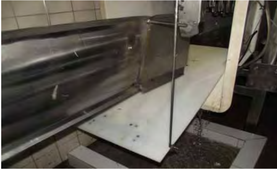
Figura 5: Rampa isolante de polietileno instalada na entrada da cuba de insensibilização em um abatedouro-frigorífico localizado no noroeste paulista. Fonte: Do autor, 2012.
