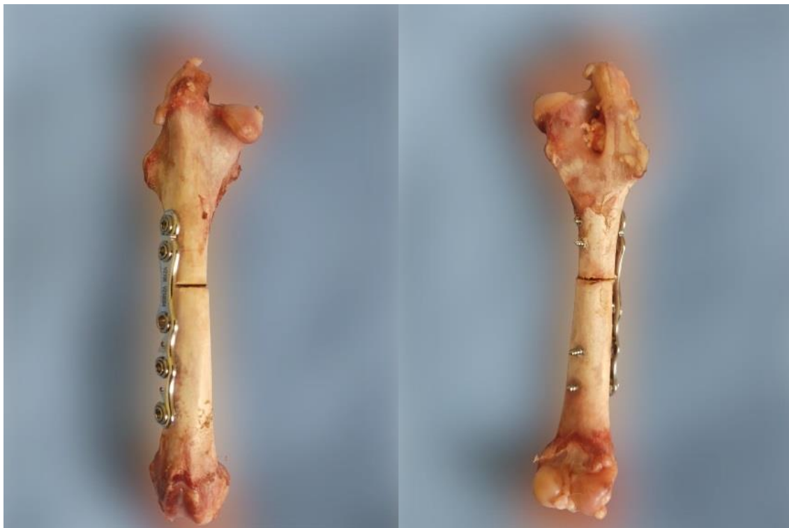
FIGURA 2. Foto da montagem no fêmur direito de coelho. Nota-se a posição da placa na superfície lateral do osso, com dois parafusos proximais ao foco de fratura e três distais, sendo a fratura transversa criada entre os orifícios de parafuso 2 e 3. A) Vista craniocaudal, B) Vista caudocranial.
