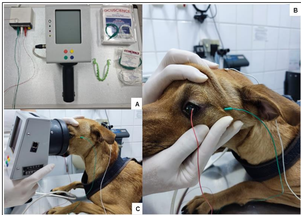
Figura 6. (A) Aparelho de ERG HM sERG da marca RetVet utilizado nos exames; (B) Detalhe da localização do eletrodo monopolar do tipo “ERG-jet lens” sobre a córnea (seta) e dos eletrodos referência próximo ao olho esquerdo (asterisco) e terra (acima da crista occipital) em um canino; (C) Posicionamento do aparelho HM sERG em frente ao olho avaliado, o pré amplificador e o decúbito adotado pelos pacientes durante os exames. Serviço de Oftalmologia Veterinária, FCAV-UNESP, Câmpus de Jaboticabal, SP, Brasil, 2022.
