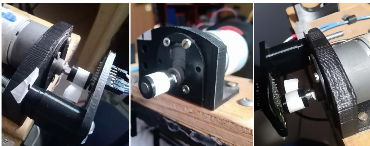
Figura 4.19 – Setup experimental para aquisição dos dados do motor CC sem influência de nenhum elemento do robô usando o primeiro motor como exemplo.
