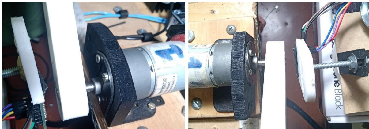
Figura 4.13 – Sensores de posição dos elos alocados fora da estrutura do robô para permitir rotação em 360° do elos durante os testes de aquisição dos parâmetros de fricção.
