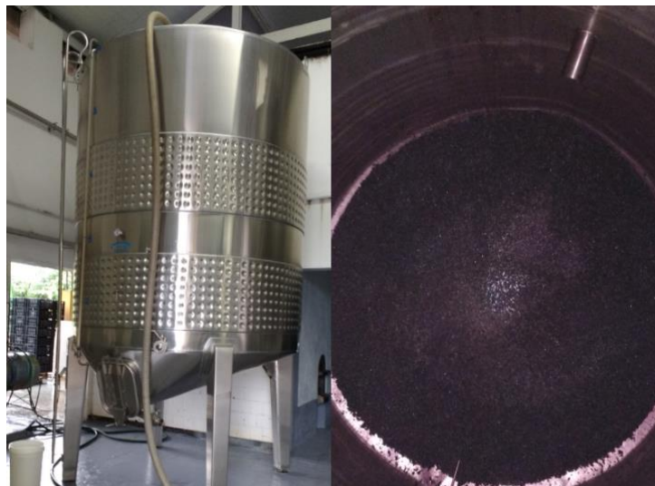
Figura 10. Etapa de sulfitação do mosto em tanque de aço inoxidável
