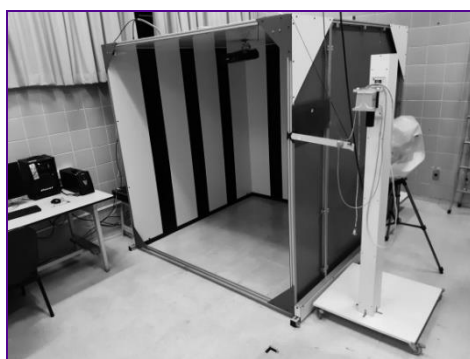
Figura 3. Imagem. Área de coleta com estrutura da Sala Móvel, composta por três paredes brancas com linhas verticais pretas, posicionada sobre trilhos.
