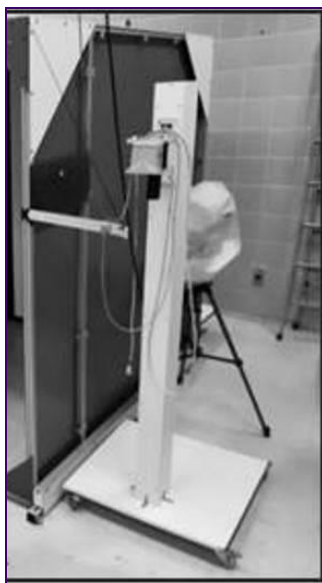
Figura 2. Imagem. Receptor e Transmissor do sistema magnético de análise de movimento Flock of Birds.
