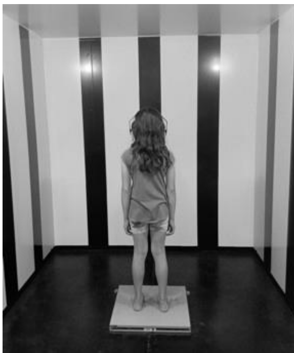
Figura 1. Imagem. Situação experimental do estudo com uma criança do grupo TEA posicionada em pé, sobre a plataforma de força, dentro da sala móvel, usando os fones de ouvido
