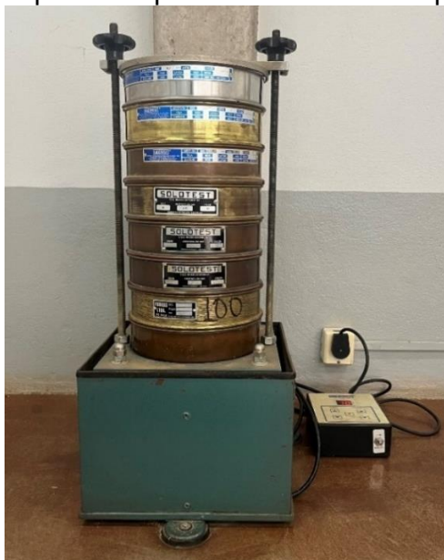
Figura 15 – Agitador de peneiras para o ensaio de composição granulométrica
