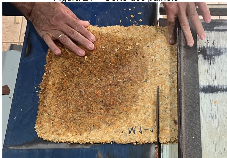
Figura 21 – Corte dos painéis
