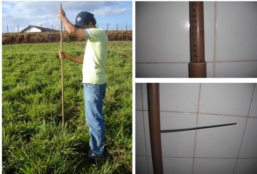
Figura 3. Régua do tipo bengala utilizada para medição de altura do dossel.
