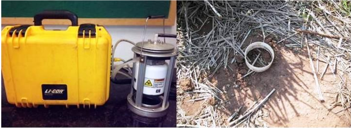
Figura 3. Câmara de fluxo LI-COR (LI-8100) e colar de PVC utilizados.
