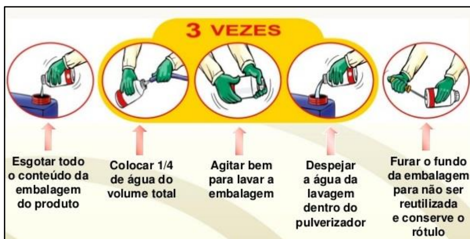
Figura 7 – Processo de tríplice lavagem
