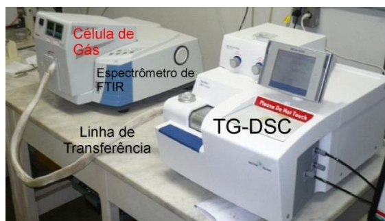
Figura 8 - Sistema TG-DSC/FTIR utilizado na identificação dos produtos gasosos.
