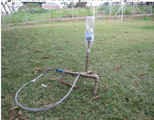
Figura 4. Sistema de Lançamento de Foguete
