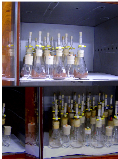
Figura 3: Respirômetros de Bartha e Pramer
