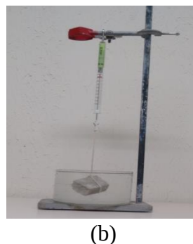
Figura 12 – (a) Esquema da balança hidrostática para determinação da massa dos corpos de prova; (b) Balança hidrostática utilizada (aparato experimental).
