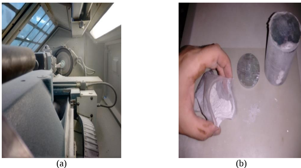
Figura 4 – (a) Detalhe interno do torno transformando o resíduo em pó; (b) Resíduo em pó e sólido.
