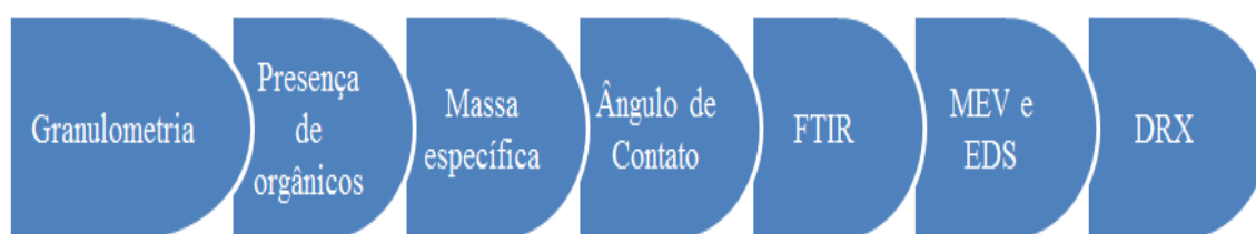
Figura 5 – Etapas caracterização do resíduo e agregado miúdo da argamassa
