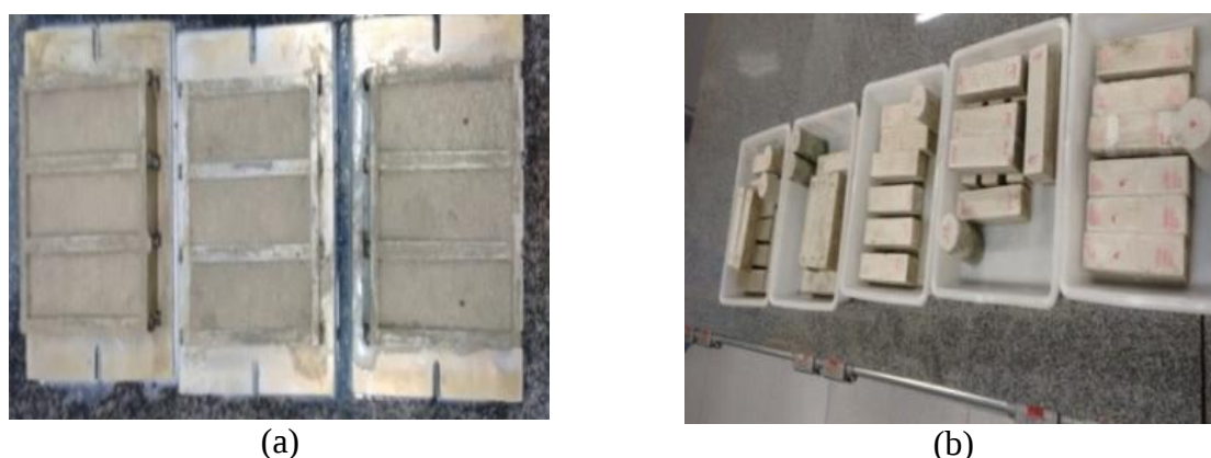
Figura 8 – (a) Processo de moldagem dos corpos de prova; (b) corpos de prova desmoldados após 48 horas (40 x 40 x 160 mm).
