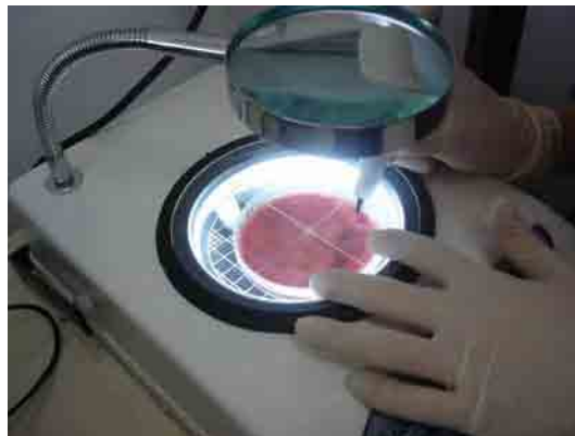
Figura 8 - Contagem das unidades formadoras de colônia em contador de colônia
