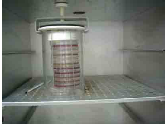
Figura 7- Jarra de anaerobiose contendo gerador de anaerobiose em estufa à 37° C
