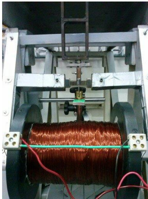
Figura 17 – Dispositivo experimental com eletroímã confeccionado para o ensaio.
