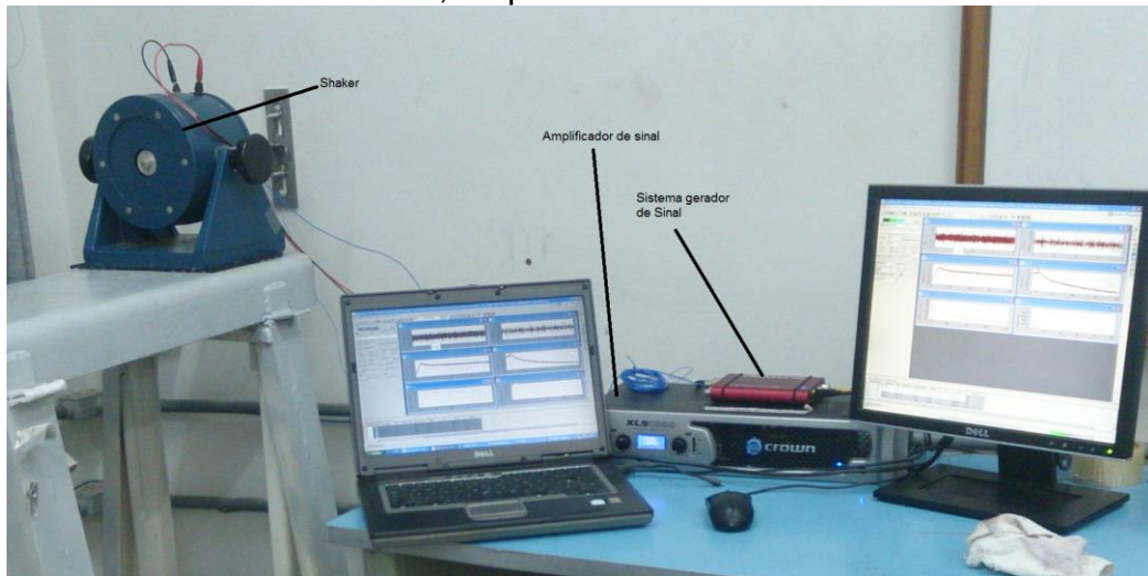
Figura 48 – Montagem experimental, mostrando sistema de aquisição, gerador de sinal, amplificador e shaker
