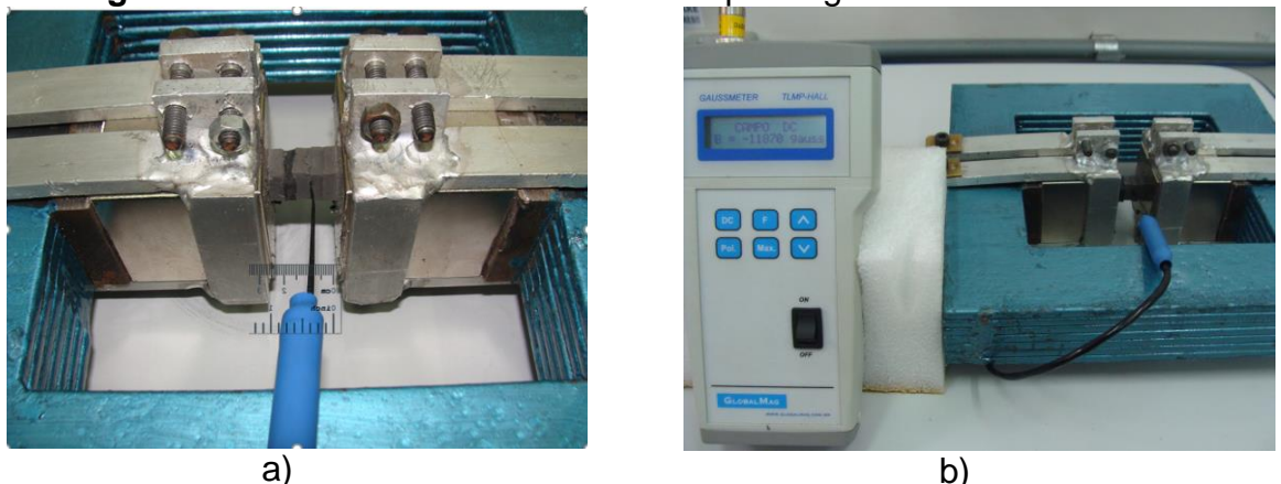
Figura 20 – Gaussímetro medindo o campo magnético entro os ímãs.
