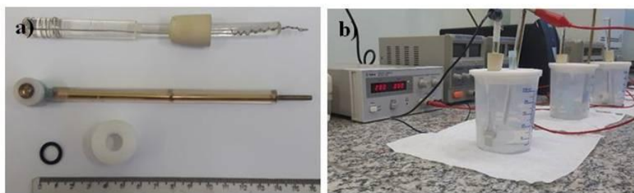
Figura 27 – (a) Material utilizado durante o processo de oxidação anódica: eletrodo de platina e porta amostra. (b) Célula durante anodização.
