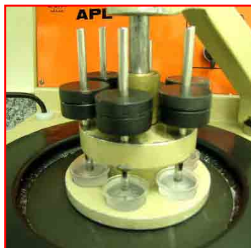
FIGURA 33. Amostras posicionadas na politriz, para realização do polimento.
