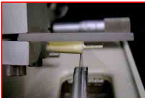
FIGURA 28. Corte inicial de 1mm para obtenção de paralelismo para o cortes seqüenciais.
