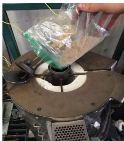
Figura 14. (a) Equipamento completo de torrefação, (b) Torrefador desmontado, (c) Momento de inserção da biomassa na torre de aquecimento do torrefador.
