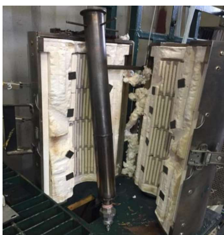
Figura 14. (a) Equipamento completo de torrefação, (b) Torrefador desmontado, (c) Momento de inserção da biomassa na torre de aquecimento do torrefador.
