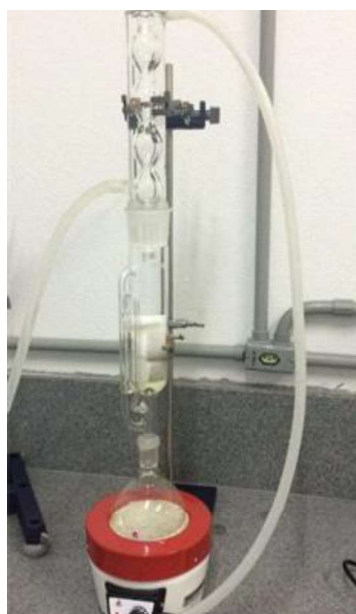
Figura 20. (a) Conjunto utilizado na determinação dos extrativos da biomassa; (b) Esquemático do funcionamento do extrator Soxhlet (Fonte: autoria própria)
