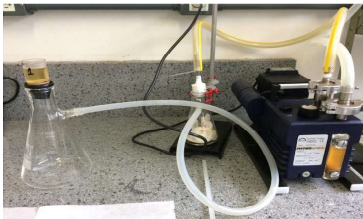
Figura 21. Conjunto de filtragem a vácuo do hidrolisado
